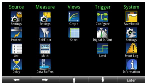
Nesta tela, você pode selecionar os menus de ajuste de fonte, medição, exibições, acionamento e sistema. Estes menus permitem que você escolha as opções para ajustar o instrumento de acordo com a aplicação. Selecione um item de menu rolando pelo controle de navegação ou usando as teclas de setas para destacar um ícone. Depois, pressione **ENTER**.
