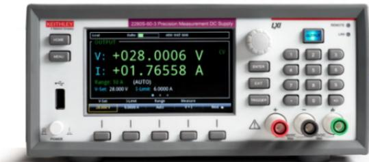
O painel frontal do Series 2280 permite ajustar a maioria das funções e recursos do instrumento e executar as operações de fornecimento e medição. O painel frontal inclui:
