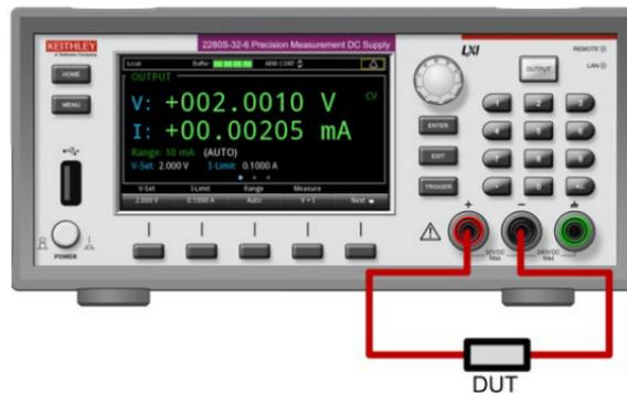
A ilustração a seguir mostra as conexões de cabo duplo (detecção local) do DUT ao painel traseiro.
